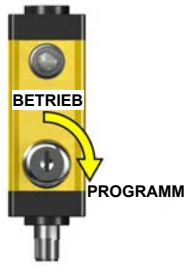
Abbildung 29. EZA-RBK-1-Schalterstellungen und Statusanzeigen bei der Programmierung.
