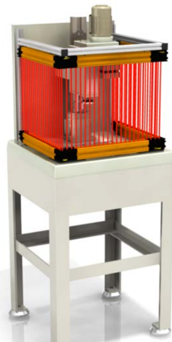
Abbildung 43. Kaskadierte Lichtvorhänge zum Schutz einer u-förmigen Roboterzelle
